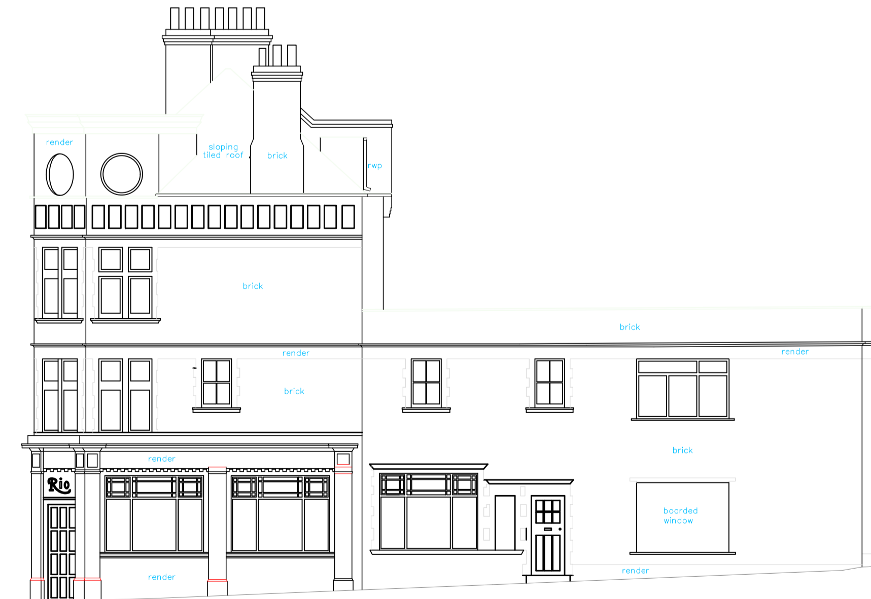
6 Existing Side Elevation Scale: 1:100
